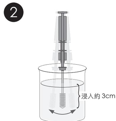
2 將採樣棒尖端浸入到水樣或液體樣品約3cm深度處，輕微搖晃。注意保證不要讓水泡附著於採樣棒尖端上。
